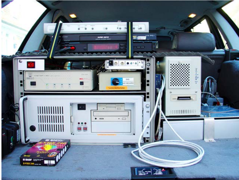
Abbildung 64. Die Rechner- und Videoausstattung des Versuchsfahrzeugs. Links unten im Einbaurahmen der Fahrdatenrechner, rechts der zweite Versuchsrechner. Oben S-VHS-Videorecorder und Videokanalnmischer. Weiter sind Bildschirm- und Tastaturumschalter sowie das LAN-Hub zu sehen
