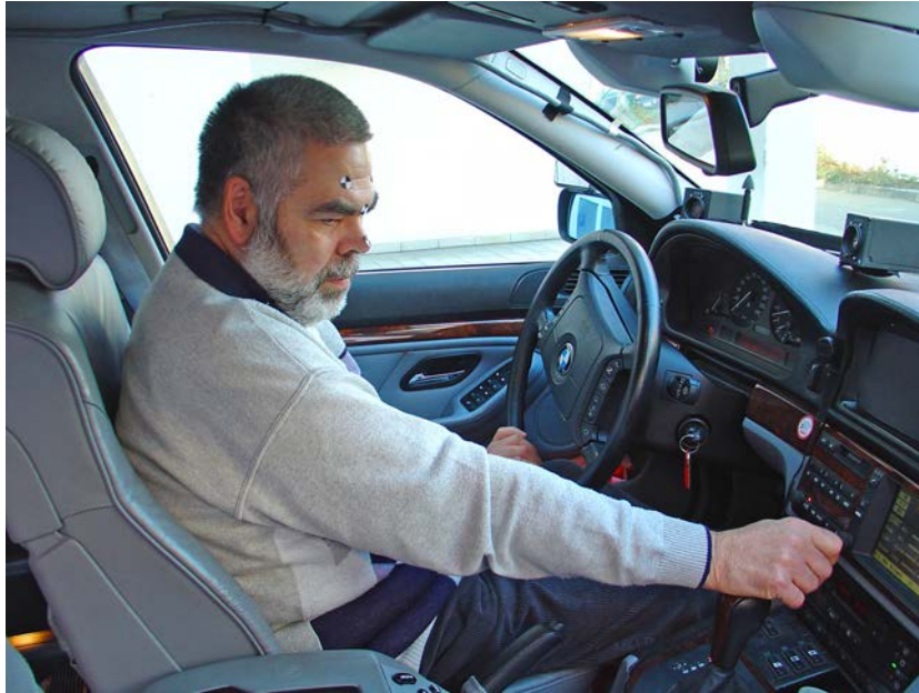
Abbildung 66. Eine Vp bei der Einweisung in die Bedienung des Carin-Navigationssystems. Im Gesicht trägt sie die FaceLab-Marker. Links und rechts oberhalb der Tachometerkonsole sind die beiden FaceLab-Video-kameras zu sehen. Oben rechts sind links und rechts vom Innenspiegel die Gehäuse der beiden auf den Fahrweg gerichteten Videokameras zu erkennen. Oberhalb des Carin-Systems befindet sich ein Bildschirm für Versuchszwecke, der nicht benutzt wurde und daher mit schwarzer Pappe abgedeckt war
