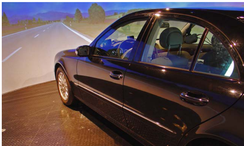
Abbildung 5. Das Versuchsfahrzeug im Projektionsdom, Mercedes-Benz E, W211 . Für einen maximalen Kontrast der Projektion wird die im Foto erkennbare Raumbelichtung während der Fahrt ausgeschaltet
