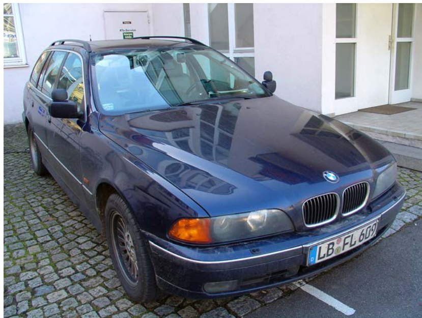
Abbildung 63. Das Versuchsfahrzeug. Links und rechts vom Innenspiegel sind die beiden auf den Fahrweg gerichteten Videokameras zu erkennen. Die Außenspiegel tragen Zusatzspiegel für die Fahrlehrerin
