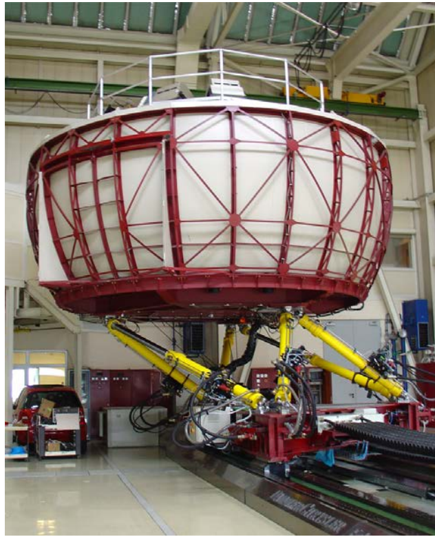
Abbildung 4. Der Fahrsimulator von Daimler-Chrysler zur Versuchszeit, Bewegungssystem und Projektionsdom
