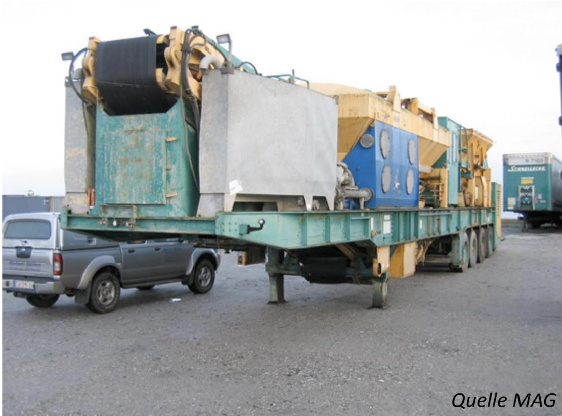
Anlage zur Verfestigung von kontaminierten Böden, Schlämmen und flüssigen Schadstoffen (separieren, homogenisieren, mischen, verfestigen)
