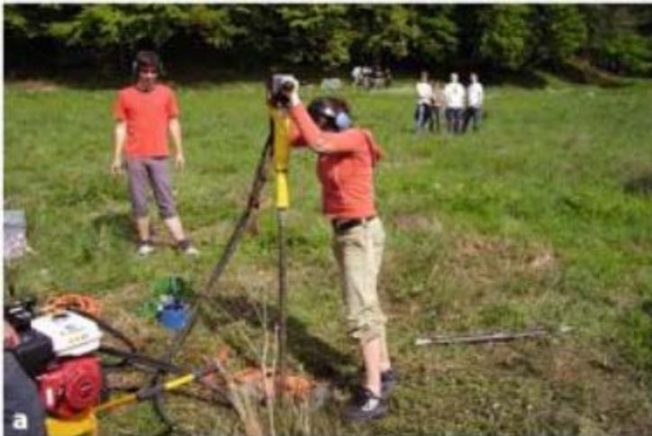
Entnahme von Bodenproben
