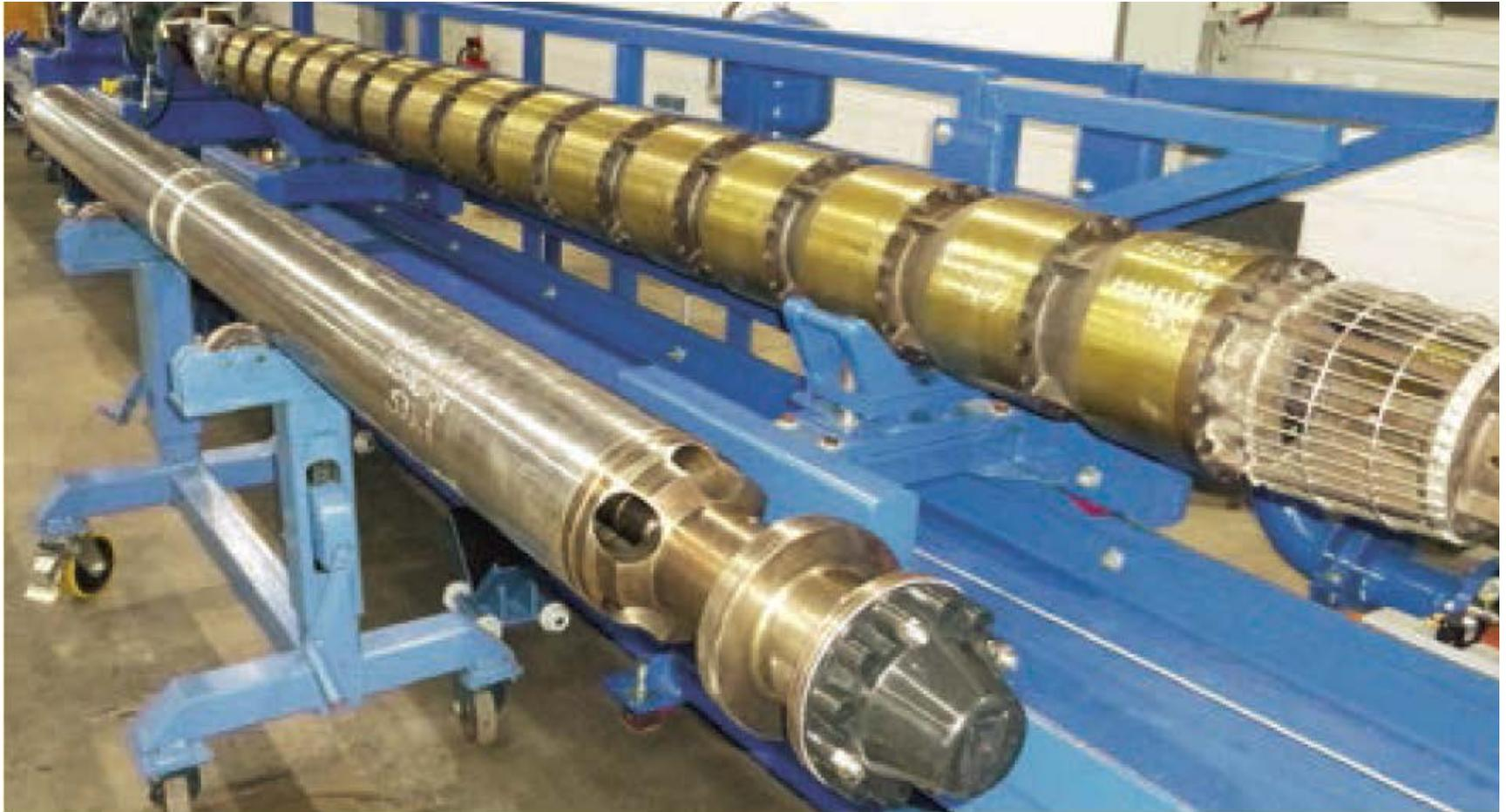
*Abb. 1 Pumpenprototypen für unterschiedliche Förderraten
