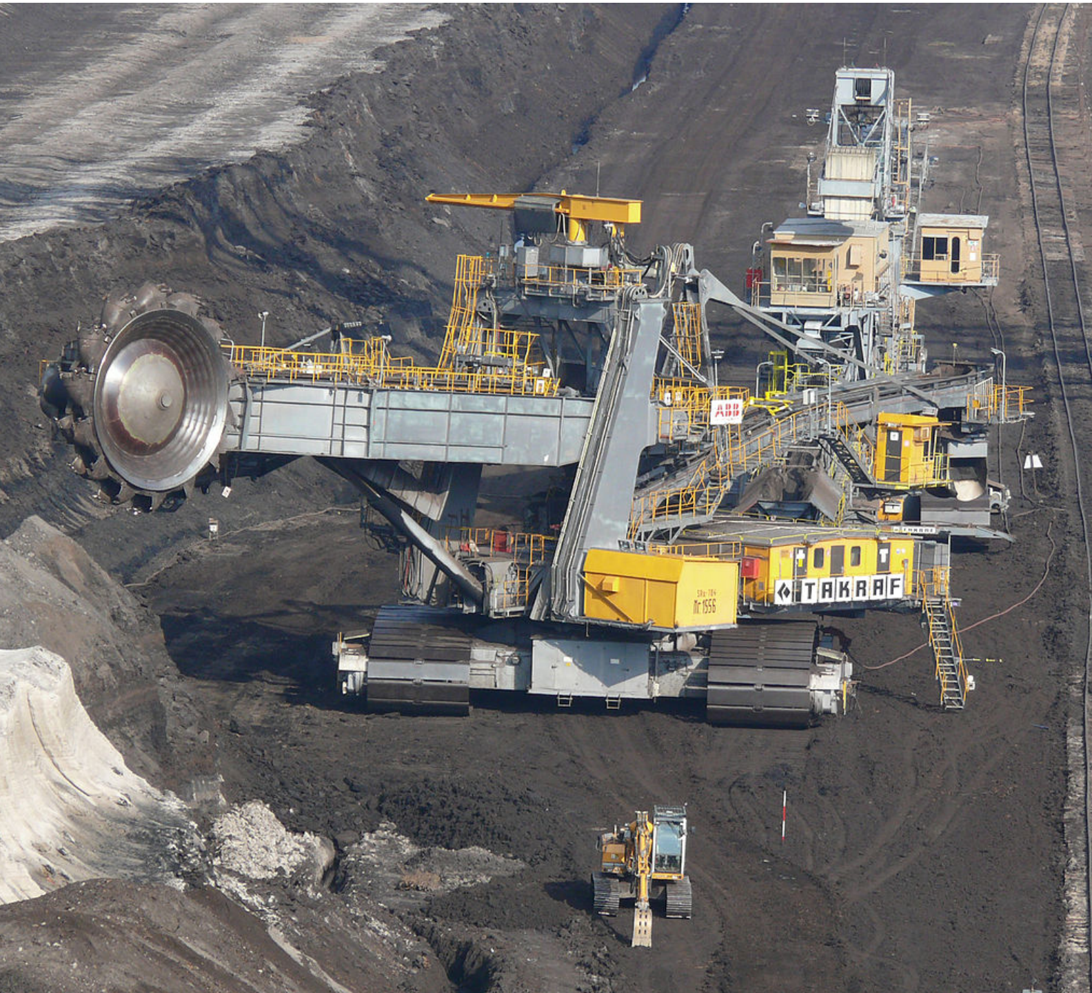
Größen- vergleich zwischen Schaufel- radbagger (1556SRs) und Mobil- bagger
